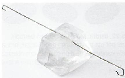
5.27. irudia. Presioa eginez, izotzezko kubo bat zeharkatu dezakegu alanbre batekin. Presioa handitzeak uraren urtze-tenperaturak behera egitea dakar , likido-egoerara pasatzen da eta alanbreak aurrera egin dezake beherantz. Alanbrearen gainean, presio atmosferikoan, ura solido bihurtzen da berriz ere.
